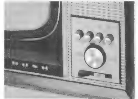
Ein raumsparender „1964er-Schalter“ nach den Empfehlungen des Pilkington-Ausschusses zum einfachen Umschalten von 405 auf 625 Zeilen in einem Empfänger der Firma Bush
