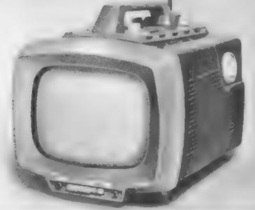
Portarama, ein tragbarer Batterie-Fernsehempfänger mit 21-cm-Bildschirm. Er ist auch am Lichtnetz und an der Wagenbatterie zu betreiben. Gewicht etwa 5½ kg, Preis rund 715 DM
